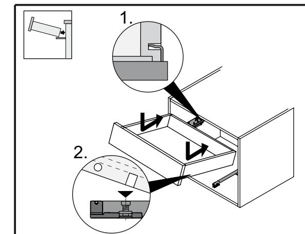
Собранный ящик устанавливаем на направляющие совмещая отверстие в задней стенке ящика с крючком на направляющей и отверстие на нижней грани боковой стенки ящика с установочным штифтом.
