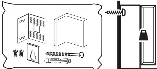
Крепежные средства идущие в комплекте, предназначены только для стен из бетона и полнотелого кирпича!
