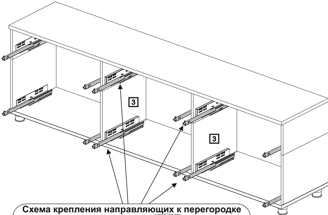
Схема крепления направляющих к перегородке
